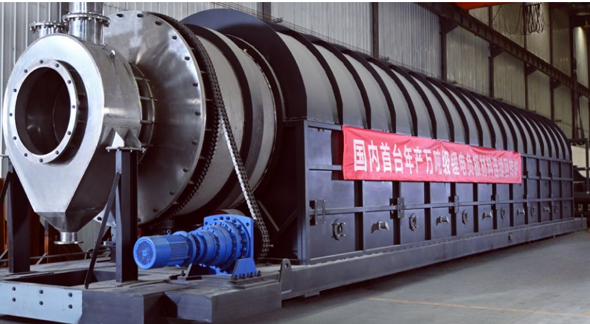
国内首台套年产万吨级锂电负极材料连续回转炉
