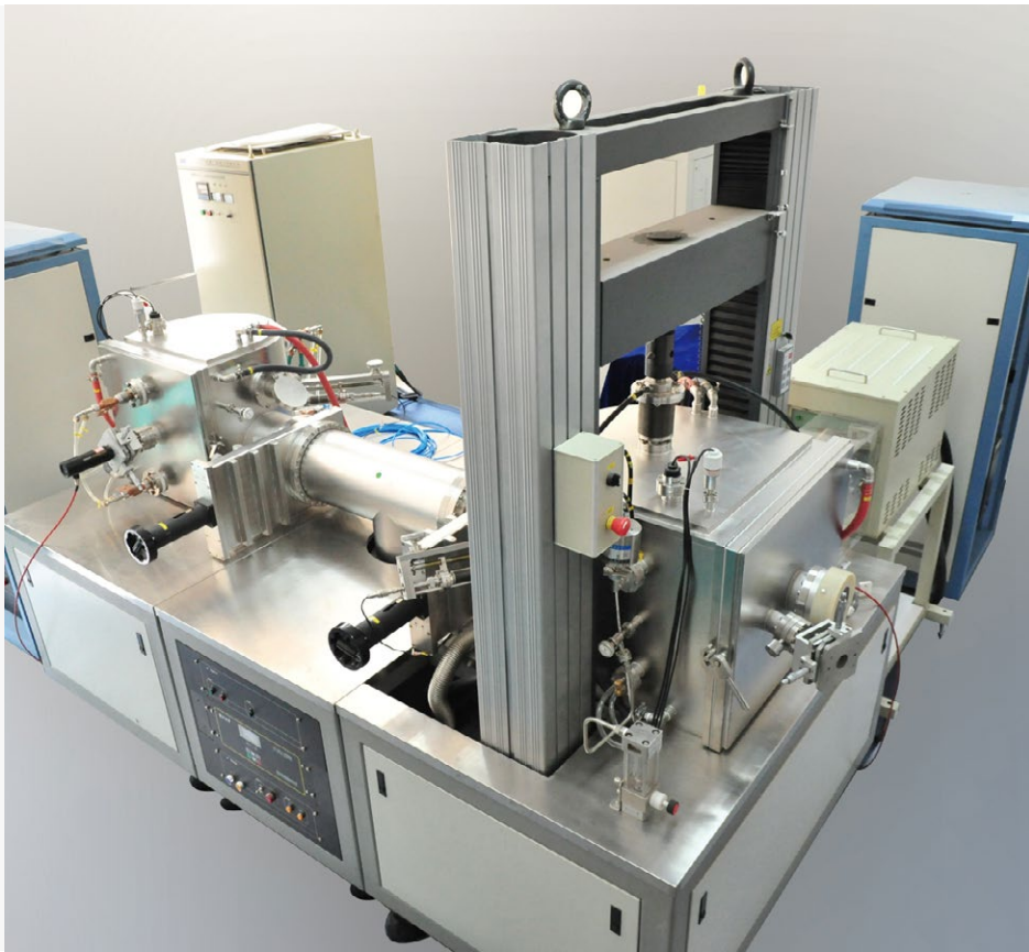
极端环境下陶瓷材料力学性能测试仪器
