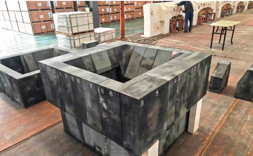
焦耳炉用熔铸 AZCS 耐火材料
